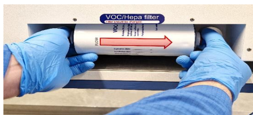
12.2 pav. LOJ ir HEPA filtro įdėjimo ir išėmimo procedūra
